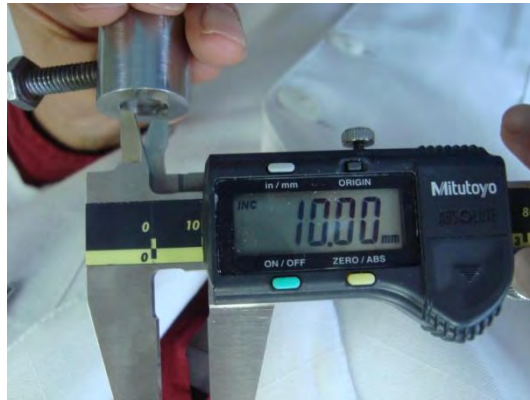
Foto 3.- Hacedor de muestras con 10 mm de diámetro medido con un Vernier (propia)
