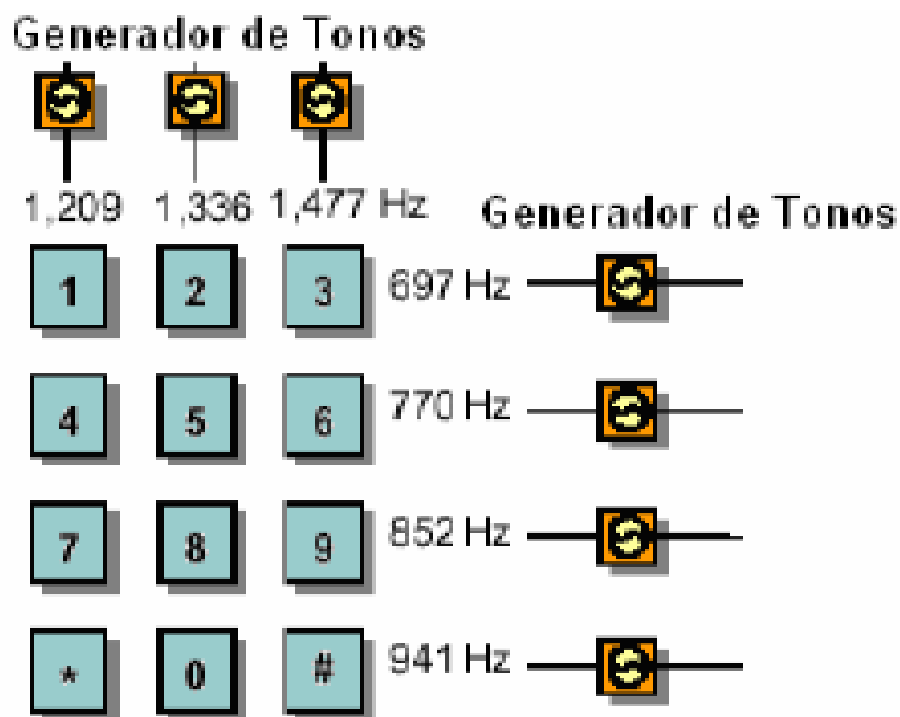
Fig. 6.2 Combinación de frecuencias en el teclado telefónico
