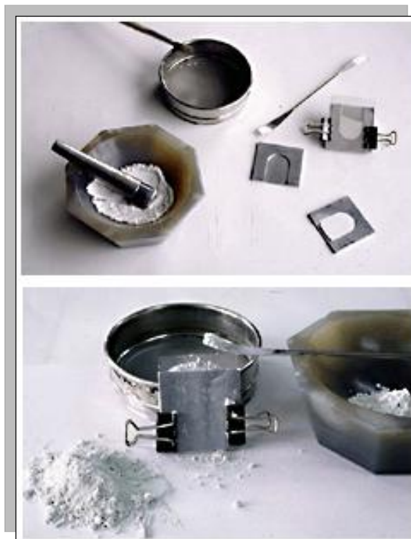
Figura 15. Montaje de las muestras para difracción de rayos X.
