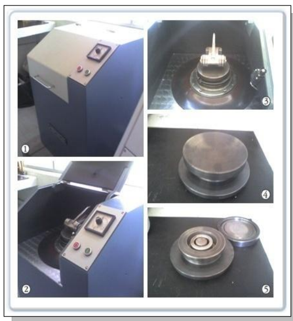
Figura 13. Pulverizador de anillos de carburo de tungsteno; (1) equipo cerrado, (2) equipo abierto, (3) sistema de anillos dentro del equipo, (4) anillos cerrados y (5) anillos abiertos.
