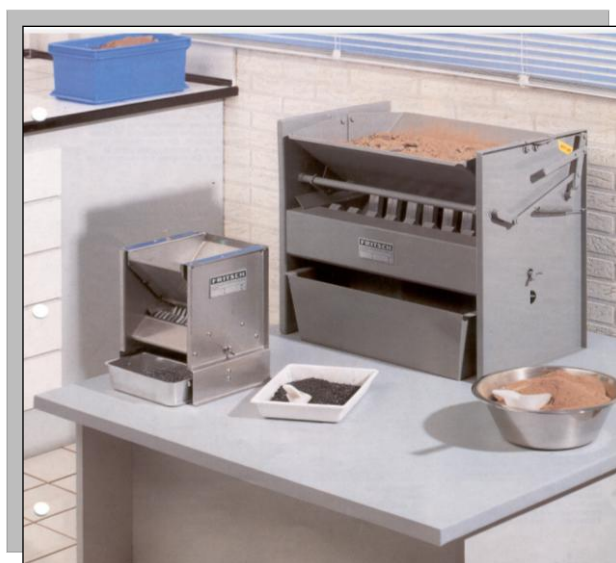
Figura 12. Cuarteador utilizado para la homogeneización.
