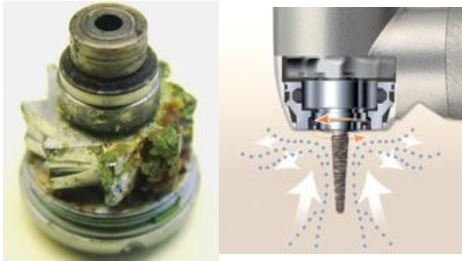
Figura 4.1. Motor de pieza de mano contaminado. 45 Figura 4.2. Retracción de fluidos orales y aire. 46
