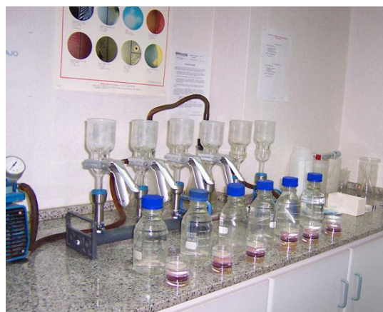
Figura 5.2. Técnica de filtración de membrana. 50
