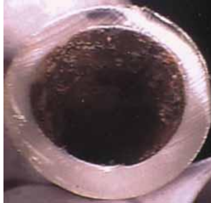
Figura 4.11. Biofilm adherido a la superficie de tubería de la unidad dental. 44
