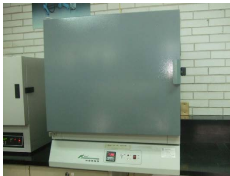
Figura 4. Estufa Felisa empleada para almacenar las muestras durante 24 horas.
