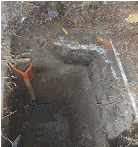
Imagen en la cual se aprecian los diferentes espesores que tiene cada estrato de suelo en este pozo.
