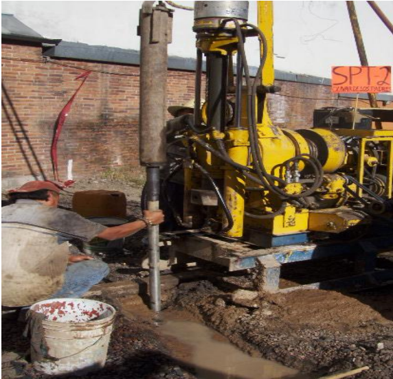
Hincado del tubo partido, con ayuda del martinete, para poder determinar el Índice de Resistencia a la Penetración, por medio del número de golpes que se realice para la incrustación del tubo partido.
