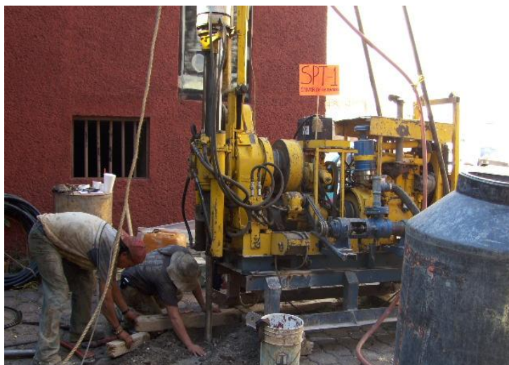
Figura - 9 Registro de Campo del Spt – 1
