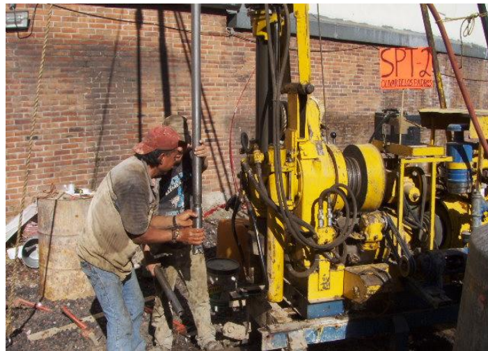
Figura - 10 Registro De Campo Del Spt-2
