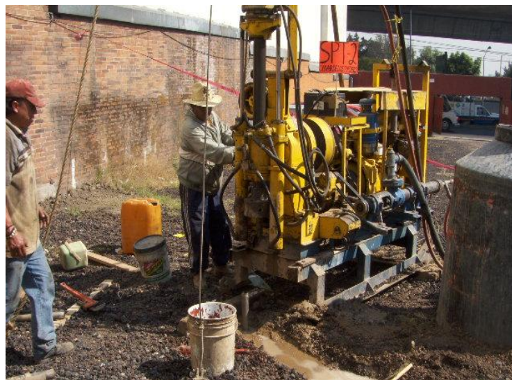
Figura - 10 Registro De Campo Del Spt-2
