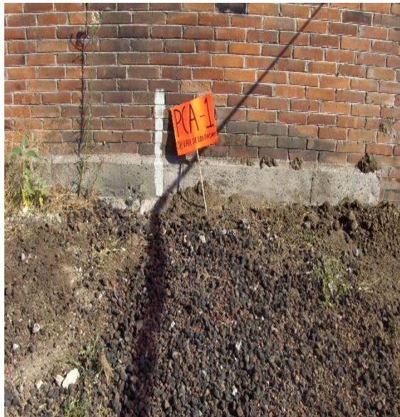
Pozo a cielo abierto No. 1, el cual al terminar de realizar la exploración y el muestreo se relleno con el material producto de su excavación.
