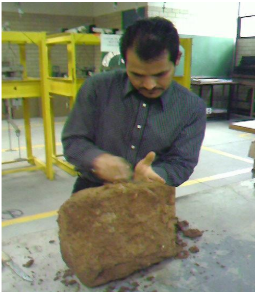
Foto – 11 Labrado de muestra cubica
