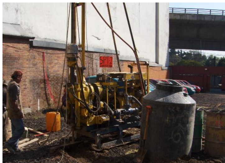
Figura - 10 Registro De Campo Del Spt-2
