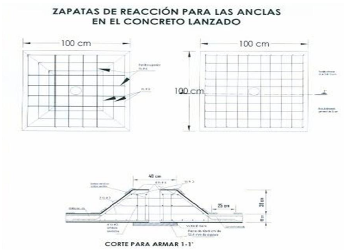
Refuerzo en el punto de aplicación del ancla
