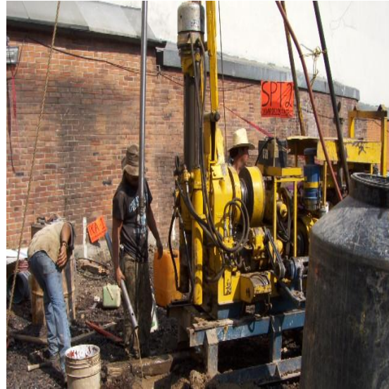
Recuperación del tubo partido con la muestra de suelo en su interior.
