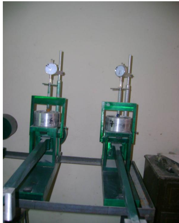
Prueba de consolidación
