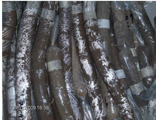
VISTA DE MUESTRAS ALTERADAS OBTENIDAS DE LOS SONDEOS PROFUNDOS
