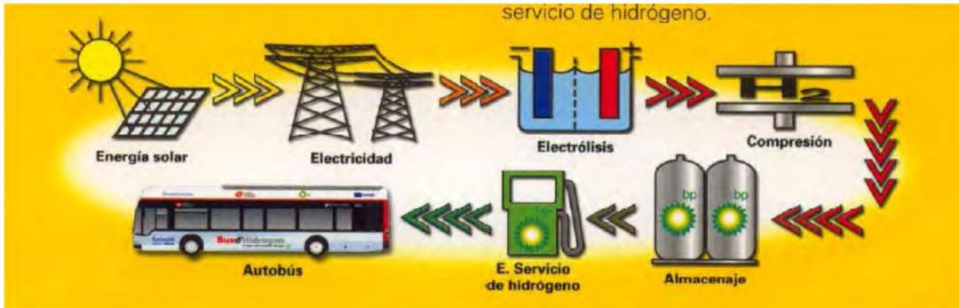
Producción de hidrógeno para el proyecto CUTE
