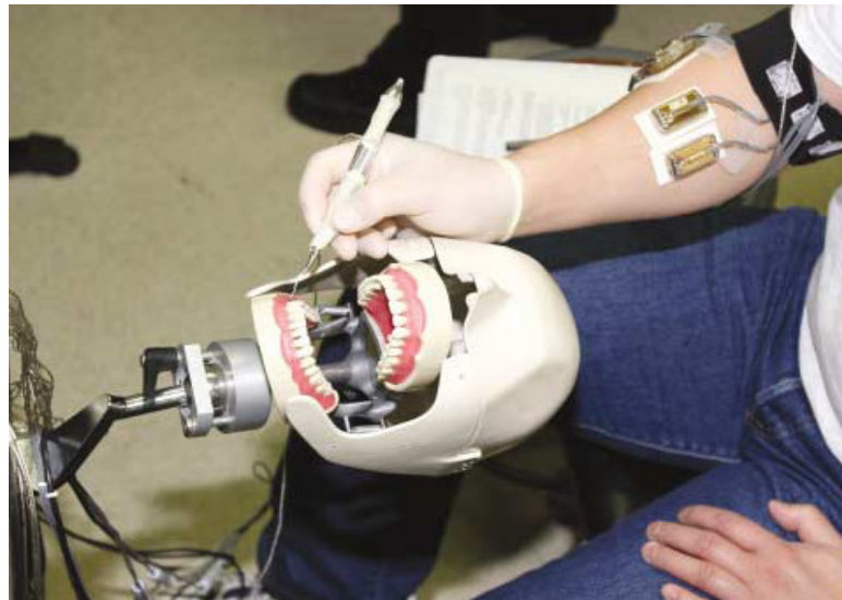
Figura 83. Escariamiento dental simulado, en maniquí que muestra las condiciones de trabajo similares a las situaciones clínicas, y los electrodos de superficie conectados al antebrazo derecho del sujeto. 78
