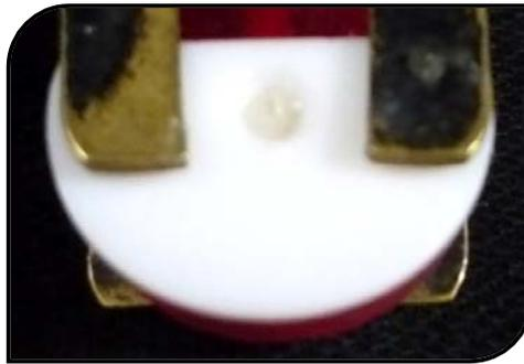
Figura 15. Ionómero de vidrio en el conformador de muestras.
