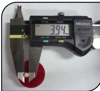
Figura 22. Medición del diámetro del cemento.
