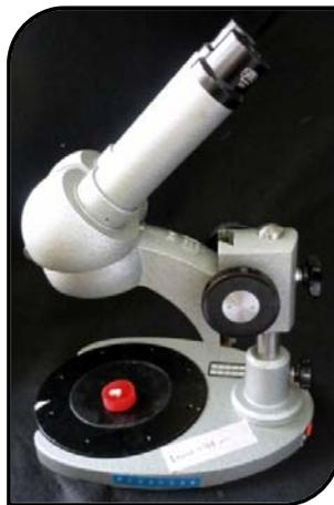
Figura 25. Microscopio estereoscópico
