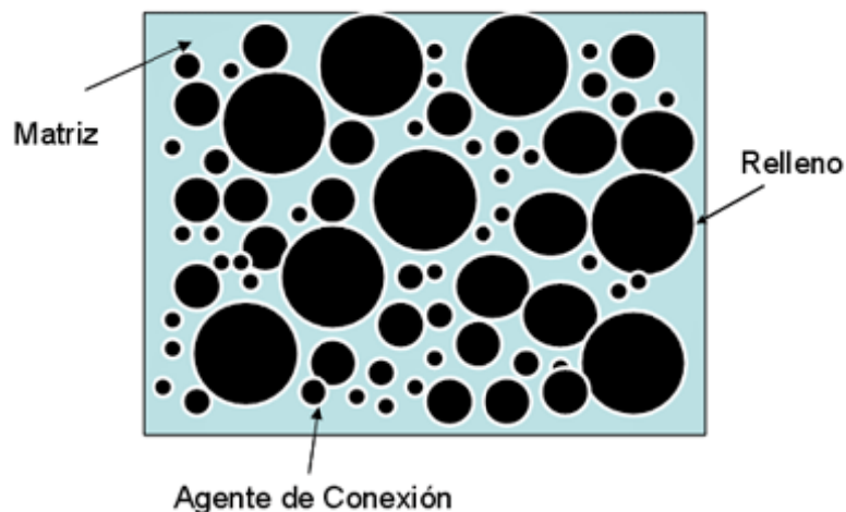
Fig. 2 Componentes de una resina compuesta.
