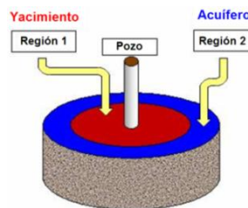
Fig. 2.11. Modelo radial con empuje lateral de agua (FAST RTA, 2010).
