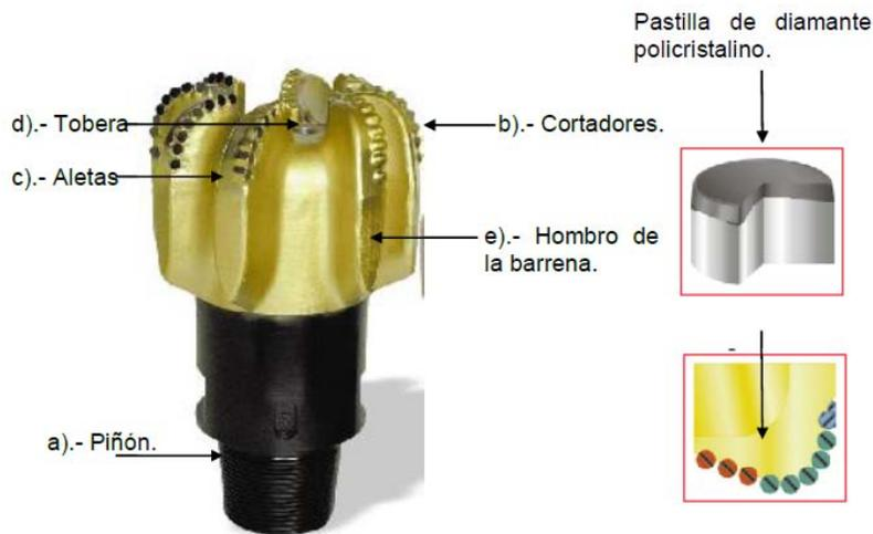
Conocimientos generales de barrenas. En la actualidad existen varios tipos de barrenas para la perforación de pozos petroleros que difieren entre sí, ya sea en su estructura de corte o por su sistema de rodamiento.
