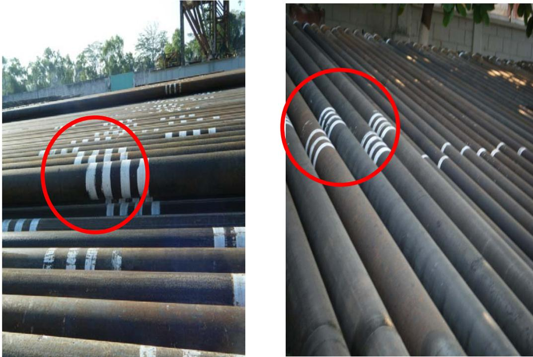
FIGURA 1.4. EJEMPLO DE UNA TUBERIA DE PERFORACION DE GRADO "S"
