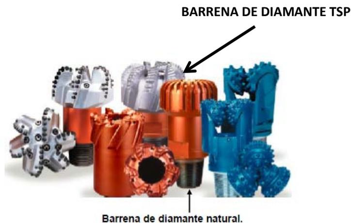
FIGURA 2.6. BARRENAS DE DIAMANTE NATURAL Y TSP
