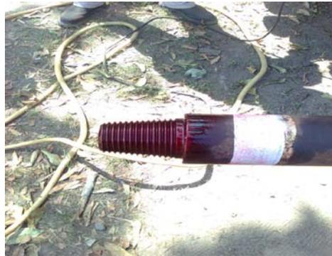
FIGURA 3.10 APLICACIÓN DEL LÍQUIDO PENETRANTE
