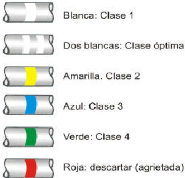
**Colores API para tubería de perforación usada**
