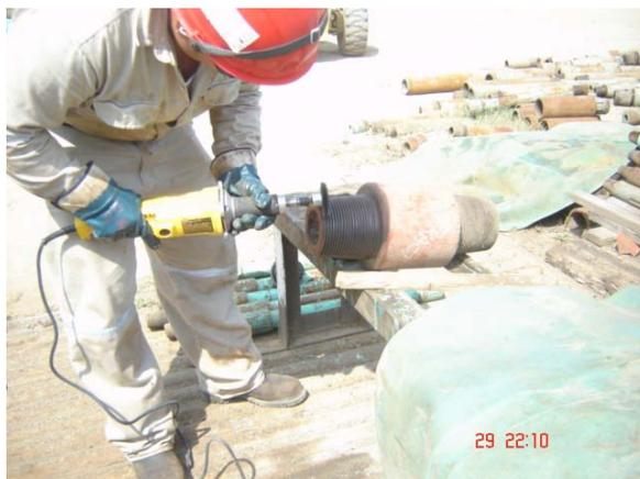
Fig.3.9 limpieza de la pieza
