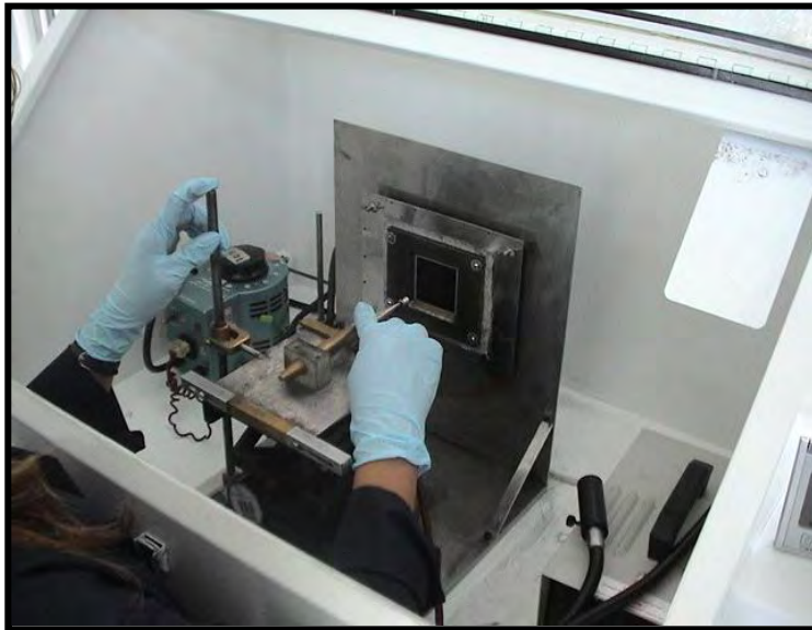
Figura 4 Sistema manual de aspersión de tinta conductora con desplazamientos x-y-z. Este sistema fue desarrollado por el grupo de investigadores de la Gerencia de Energías No Convencionales del Instituto de Investigaciones Eléctricas (Cuernavaca, Morelos).
