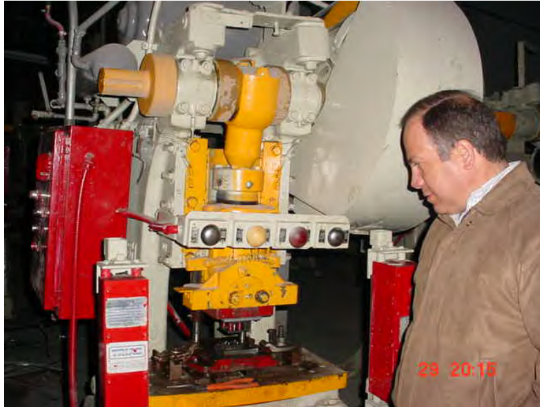
Troqueladora para estampar partes de chapa de metal
