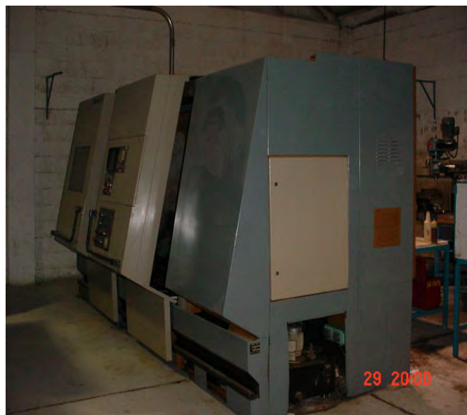
Tornos de control numérico (centro de maquinado horizontal). Fabricar piezas cilíndricas. Fabricación de turbinas para aviones, flechas para motores, ejes.
