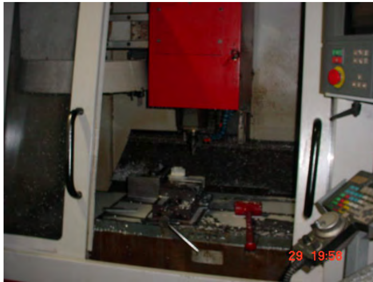
Centro de maquinado vertical (control numérico computarizado, CNC). Fabrica piezas cuadradas, triangulares, rectangulares, ovaladas, etcétera.
