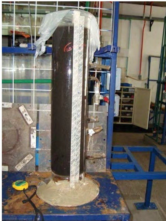
Figura 8. Fotografía de la columna que se utilizó para la sedimentación del agua residual porcícola
