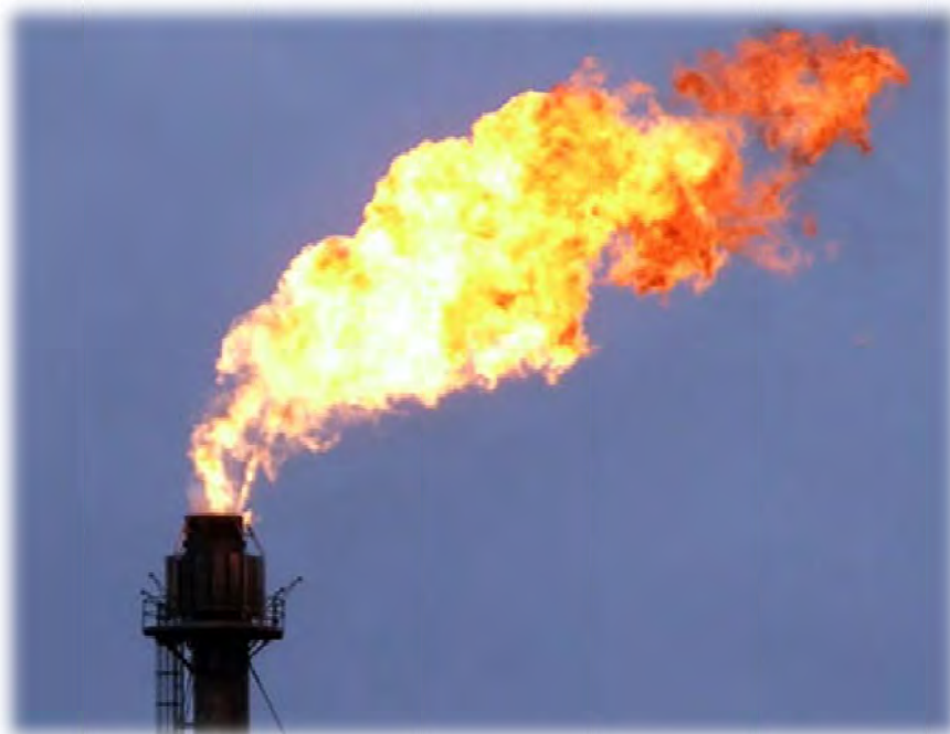
Fotografía 2.12-Efecto del Viento en la Flama del Quemador.
