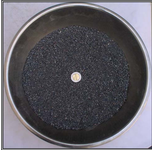
Banco La Pasión después de la prueba de pérdida por lavado.
