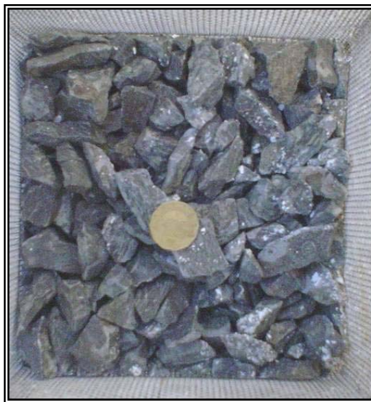
Grava del banco La Pasión después de la prueba de intemperismo acelerado.
