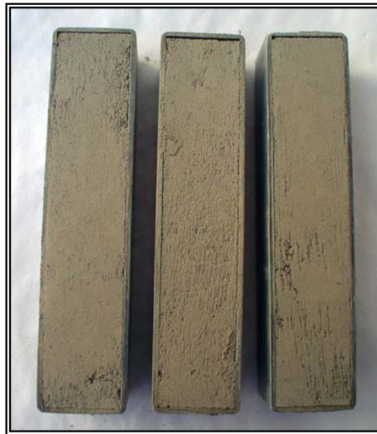
Contracción lineal del banco La Pasión.
