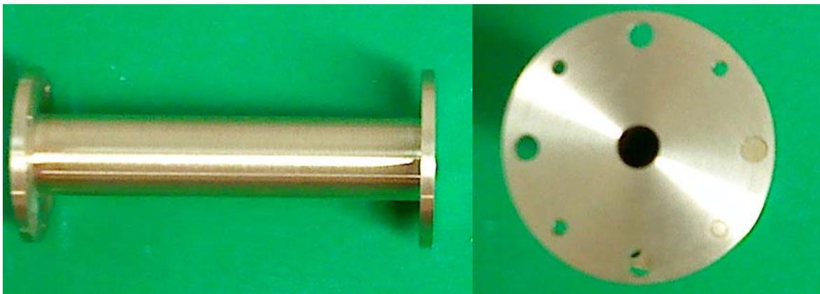
Figura 4-18. Vista superior y lateral de Guía de Onda utilizada para medición con “Carga Estándar”
