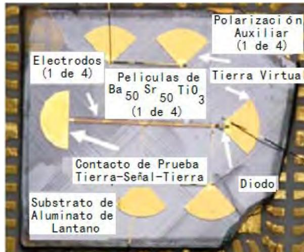
Figura 1-9. Desplazador de fase híbrido ferroeléctrico/semiconductor [tomada de [3]]
