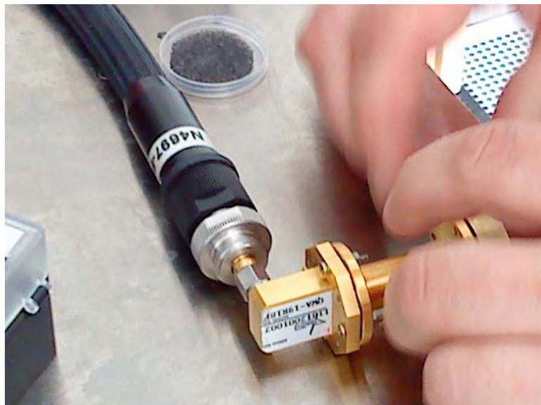
Figura 5-5. Medición realizada para prueba de calibración “short”
