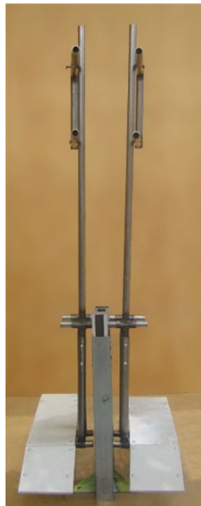
Estructura central de metal con dos palancas dispuestas a los lados, cada una con movimiento independiente.
