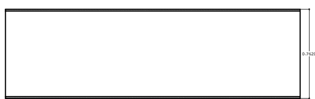
PERFIL IPC (13) ESC. 1:10 30" x 16" Pp 156.9 kg/m
