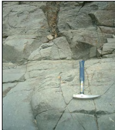
Figura 4.I.3. Afloramiento de derrames de lava con un ejemplo de fracturas conjugadas, señaladas por el martillo de longitud: 33 cm. Localización del afloramiento: Latitud 18°32'8.95'' N y Longitud 97°21'2.28'' W.
