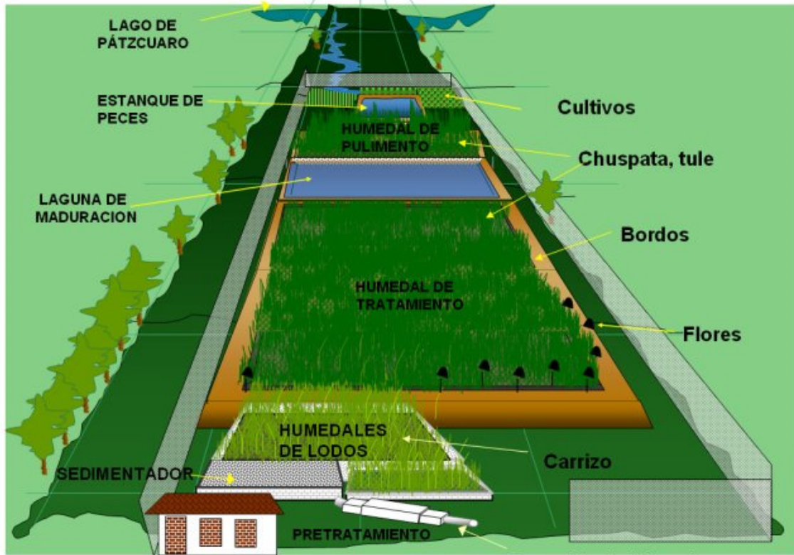
Figura A 4 Esquema del humedal de Cucuchucho
