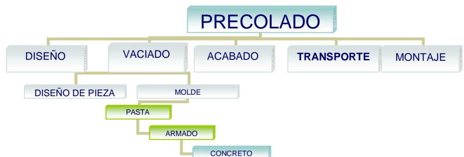
Imagen 6, Extraída con fines didácticos, Diagrama de proceso de un precolado y su Fabricación, Aut. Maribel Jaimes T.
