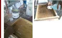
2.- Engrasado del molde Cera de apisono y poliestireno Desmoldante
