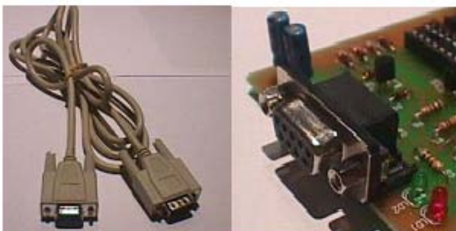
Figura 3.6 Cables serie y entrada DB9 hembra.
