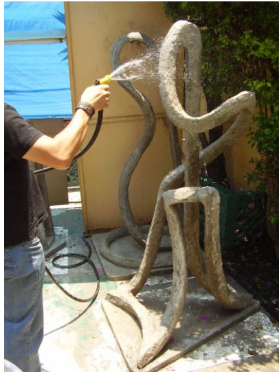
Lámina 138. Curado de piezas con agua.
