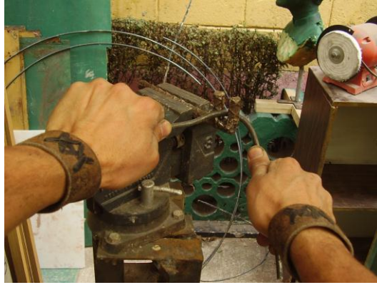
Lámina 118. Doblez de barra de acero de 1/4".
