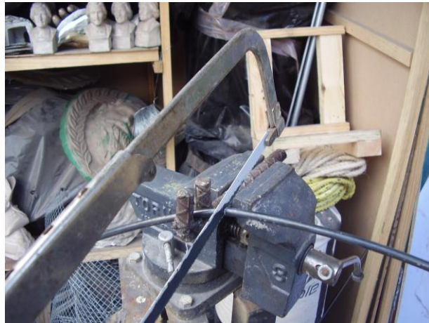
Lámina 113. Corte de barra de acero de \frac{1}{4} ".
