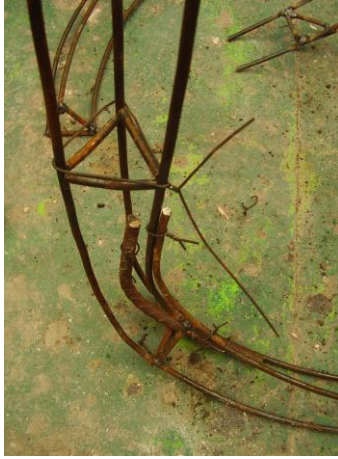
Lámina 127. Soldado con refuerzos de barra corrugada a la base.
