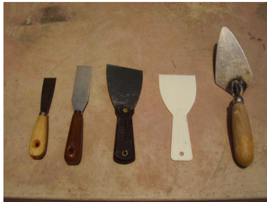
Lámina 135. Herramientas para aplicación de concreto.
