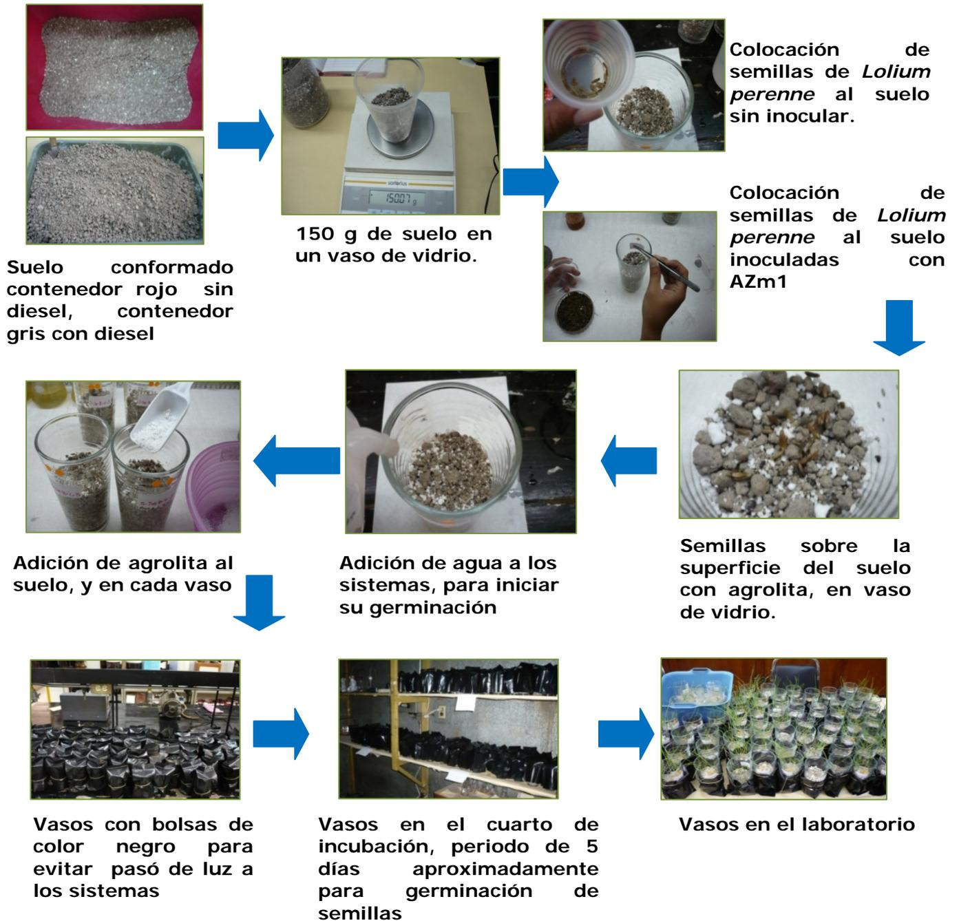
Figura 4.6 Diagrama que resume las actividades de conformación y montaje de los sistemas experimentales.
