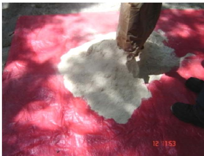
**Figura 4.2 Suelo conformado, colocación de arena, limo, arcilla.**
