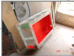
Molde de mesa para mobiliario fibra de vidrio espesor 6mm.
