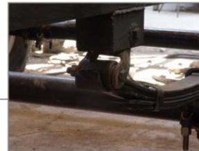
Detalle de percha fija y percha móvil.
