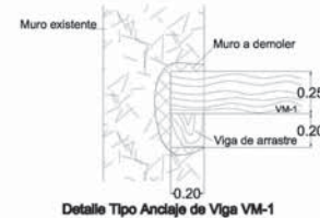
Detalle Tipo Anclaje de Viga VM-1
