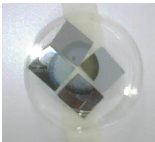
Imagen 3.9: Sustrato de silicio poroso dividido en 4
