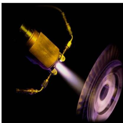
Figura 2.17 Pistola por arco de plasma, combina un cátodo axialmente alineado (1 a 2% de tungsteno toriado) y un ánodo de boquilla (cobre OFHC).<sup>44</sup>
