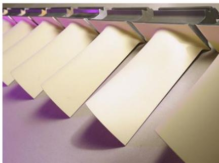
Figura 1.14 Barrera térmica de zirconia estabilizada con itrio.<sup>16</sup>
