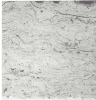
Figura 2.15 Acero rociado por arco eléctrico utilizando alambres de diámetro pequeño.<sup>42</sup>
