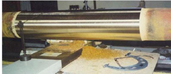
Figura 1.20 Recubrimiento maquinado. Eje listo para volver a prestar servicio.<sup>19</sup>
