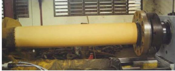
Figura 1.19 Recubrimiento de aluminio-bronce obtenido después de rociar.
