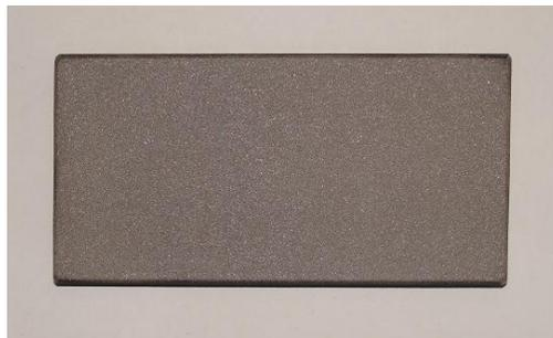
Fig. 6.4 Sustrato granallado.<sup>82</sup>
