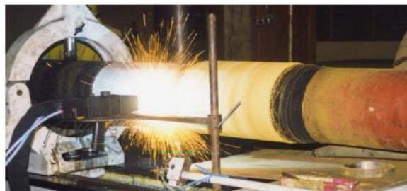
Figura 1.18 Se rocía una aleación de aluminio-bronce mediante equipo de arco eléctrico en la zona a restaurar.
