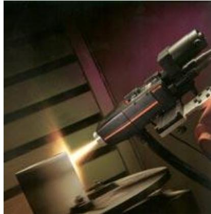
Figura 2.11 Pistola de proyección por arco eléctrico.<sup>37</sup>
