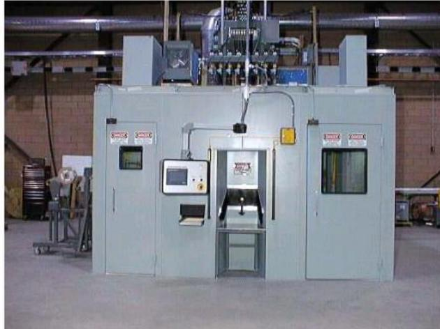
Figura 4.9 Cuarto de aislamiento acústico.<sup>71</sup>
