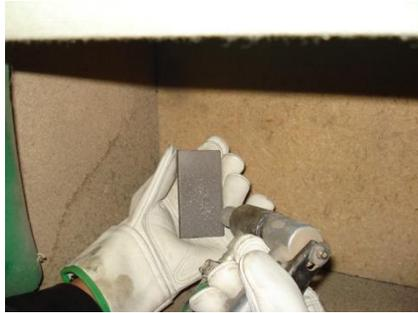
Fig. 6.2 Proceso de granallado.<sup>80</sup>
