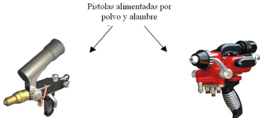
Figura 2.4 Pistolas de proyección térmica por polvo y alambre.<sup>26</sup>
