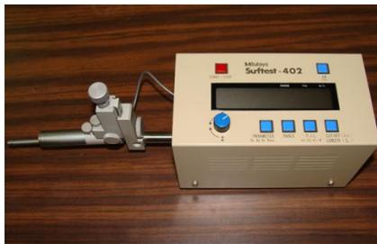
Fig. 6.3 Rugosímetro digital.<sup>81</sup>
