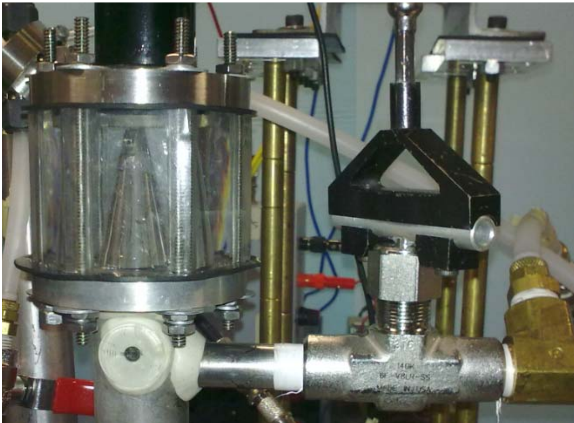
Figura 16b.- Válvula automatizada integrada en el tubo U.
