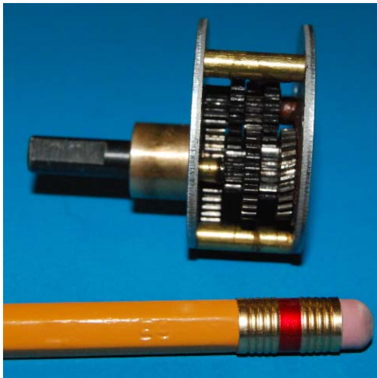
Figura 9.- Motorreductor utilizado en este trabajo.
