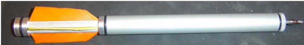
Fig. 13 Dardo metálico utilizado en equipos de detonación.
