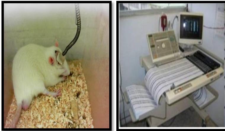
FIG 5.3. Esta foto tomada en el laboratorio de Neurociencias de la UAM-I, muestra a la derecha uno de los animales de experimentación conectado al cable para el registro PSG y a la izquierda el polígrafo realizando el correspondiente registro.
