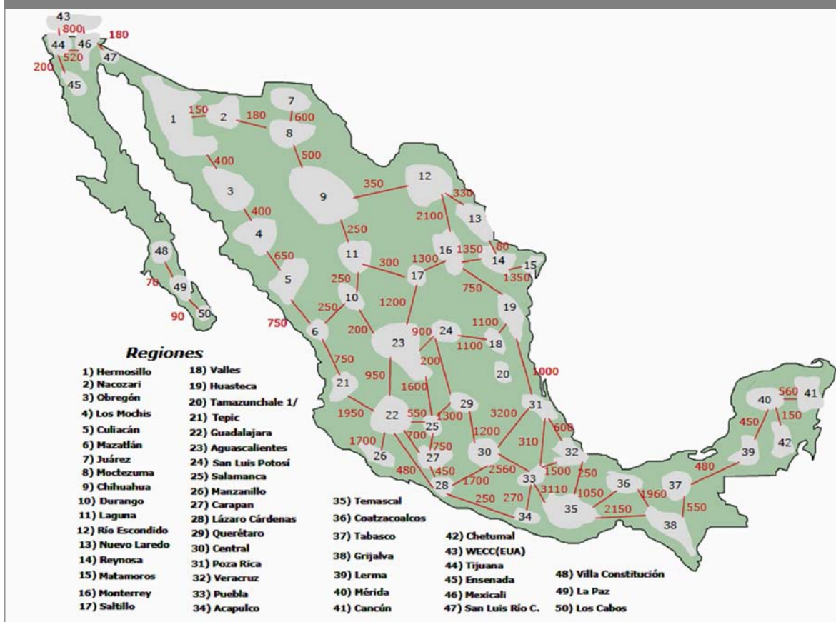
Imagen 2: Capacidad de transmisión entre regiones (MW). 1/ En 2006 esta región no se encuentra interconectada.
