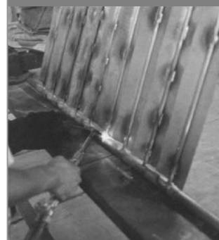
Imagen 19: Serpentin de cobre de un calentador solar
