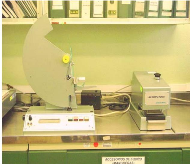
Equipo Elmendorf para la determinación de la resistencia al desgarre.
