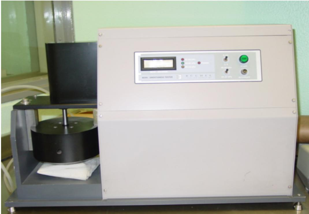
Medidor automático de lisura Bekk
