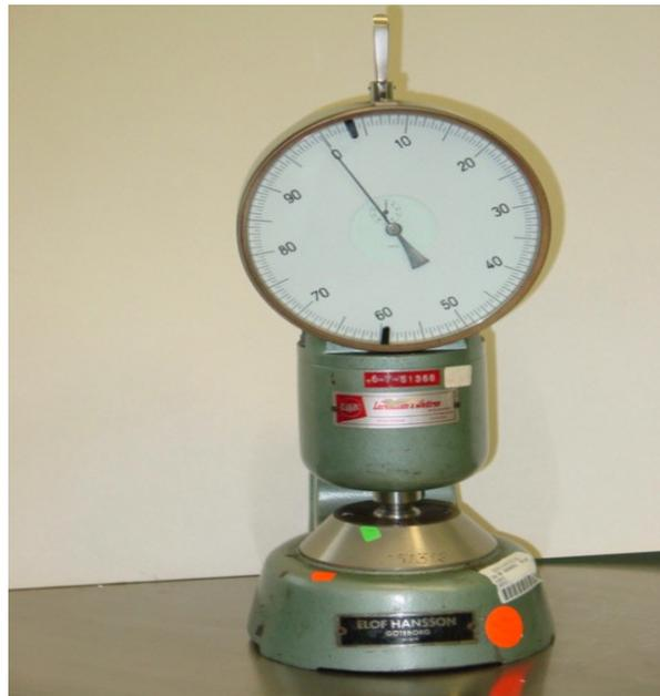
Aparato para medir el espesor
