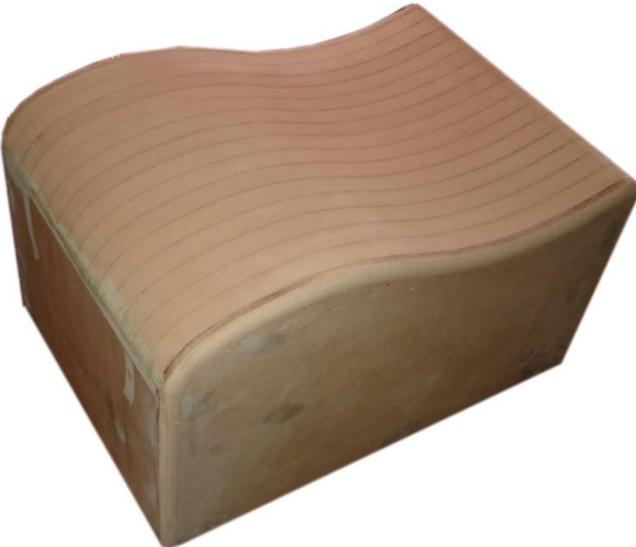
Molde de respaldo para termoformado
