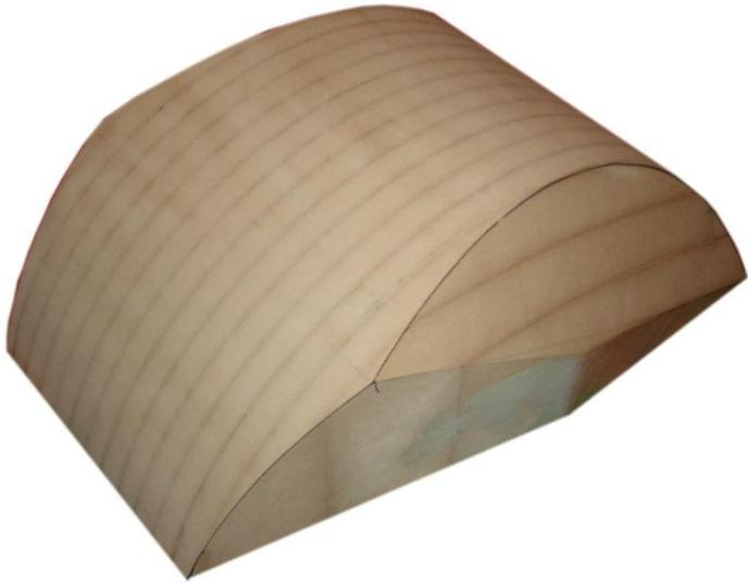
Molde de escudo para termoformado
