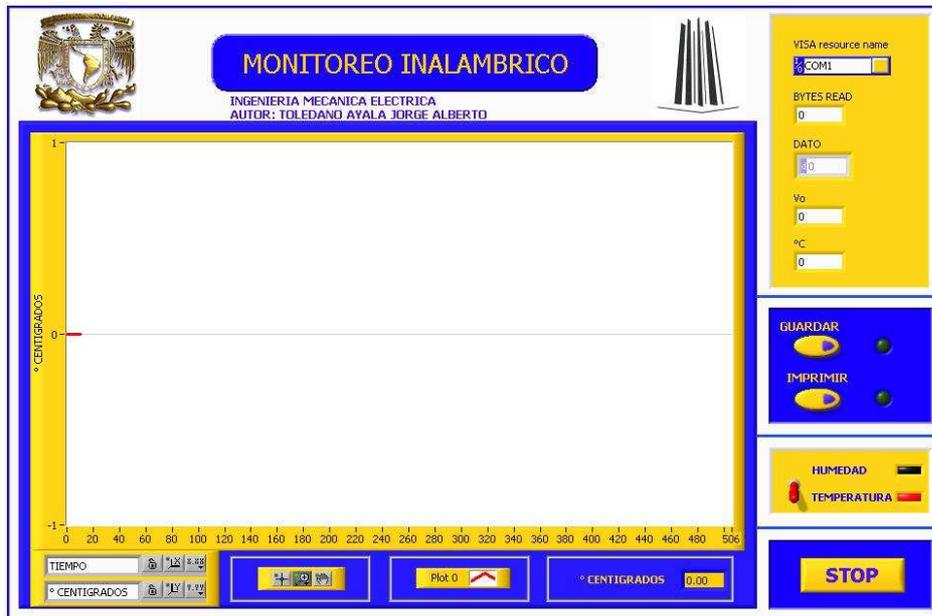
Figura 4-32 Panel frontal del sistema de monitoreo inalámbrico
