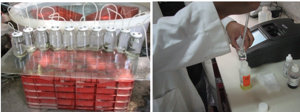
Figura 4.- Uso de cámara respirométrica y espectrofotómetro para análisis químicos.
