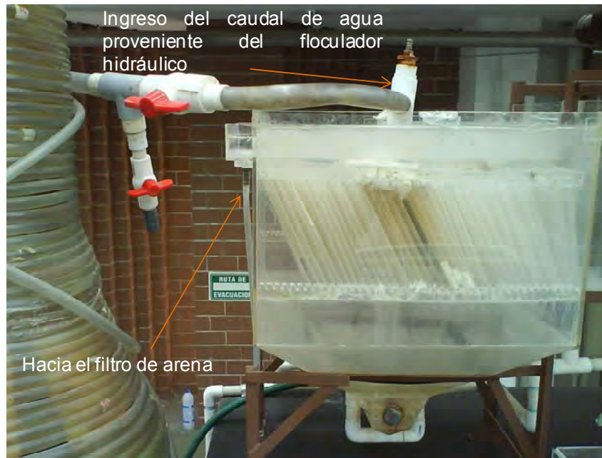
Figura 3.9. Vista superior del sedimentador de alta tasa de la unidad piloto de Electrocoagulación.
