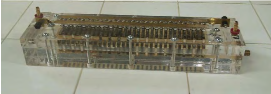
a) Reactor de electrocoagulación fabricado en acrílico
