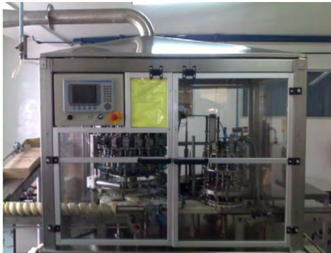
**Fig. 6.1 Tercera generación de máquina llenadora y selladora tras el rediseño sustentable. Fotografías tomadas en la Planta de producción en su actual instalación.**
