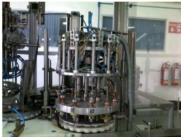
**Fig. 6.3 Cabezal de sellado. Fotografías tomadas en la Planta de producción en su actual instalación.**
