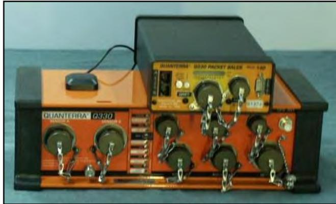
Figura II.2 Sismógrafo
