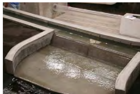
Fotos del modelo físico donde se puede observar el funcionamiento del vertedor del TEO
