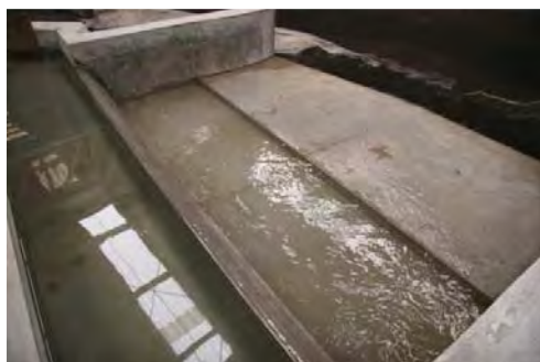
Fotos del modelo físico donde se puede observar el funcionamiento del vertedor del TEO
