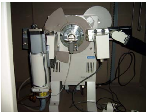
Figura 3.8. Equipo de difracción de rayos X Rigaku Dmax2200 del Departamento de Materiales solares del Centro Investigación en Energía.
