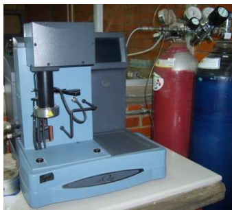
Figura 3.9. Equipo de Termogravimetría Q500 de TA Instruments.
