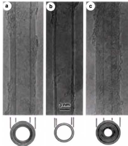
Figura 2.19. Primeras imágenes de nanotubos de carbono multipared por microscopía electrónica de transmisión reportadas por Iijima, 74 (a) diámetro: 6.7 nm; (b) diámetro: 5.5 nm; (c) diámetro: 6.5 nm.
