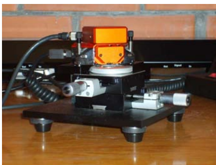
Figura 3.16. Microscopio de fuerza atómica portátil Nanosurf Easyscan2.
