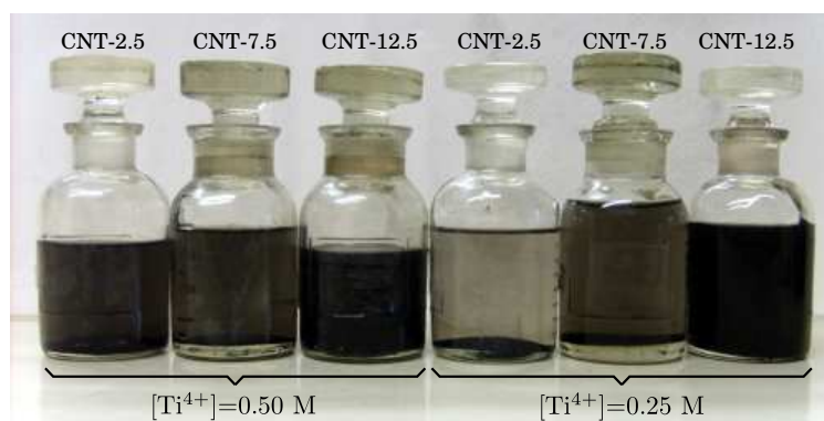
Figura 5.8. Fotografía de las soluciones sol gel de TiO_2 con CNT funcionalizados en soluciones 2.5 M, 7.5 M y 12.5 M de HNO_3 , 20 días después de preparadas.
