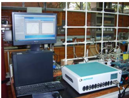
Figura 3.20. Analizador de respuesta a la frecuencia/potenciostato/galvanostato Autolab PGSTAT302N de EcoChemie.
