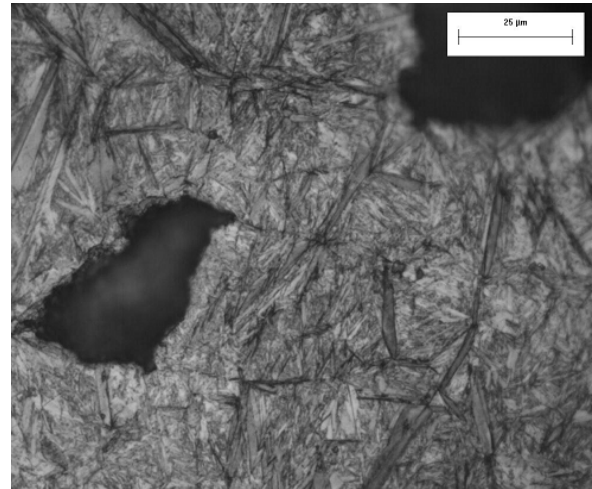
Figura 4.23.- Muestra austenizada a 875 °C durante 90 min
