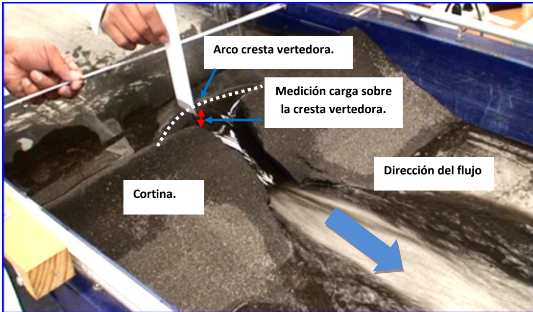
Figura 2.12 Medición de la carga real sobre la cresta vertedora (canal Posgrado de Ingeniería)
