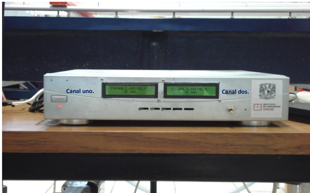
Figura 2.18 Imagen en que muestra la consola utilizada para procesar la información obtenida, por lo limnímetros electrónicos
