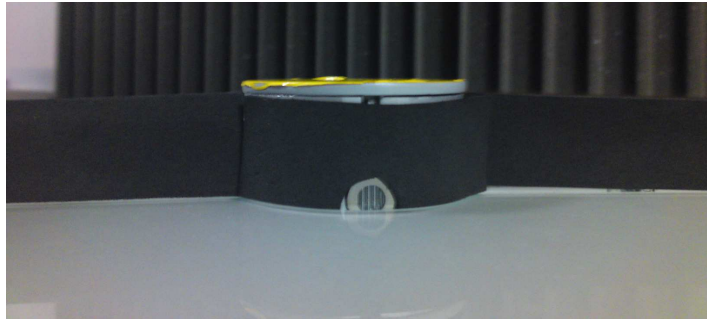
Figura 2.27. Marco de fomi colocado alrededor de la superficie.
