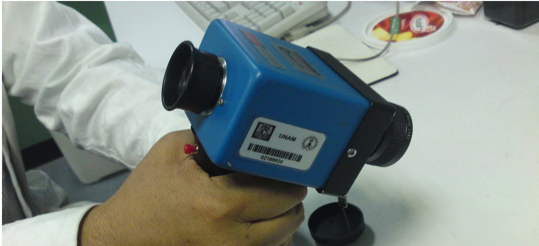
Figura 3.13. Visor de radiación infrarroja.
