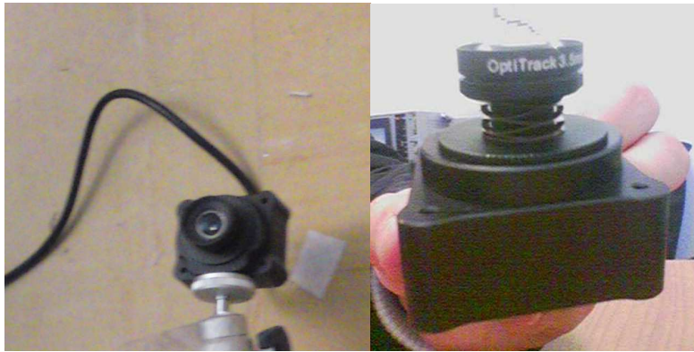
Figura 2.6. Cámara Optitrack SLIM V100.
