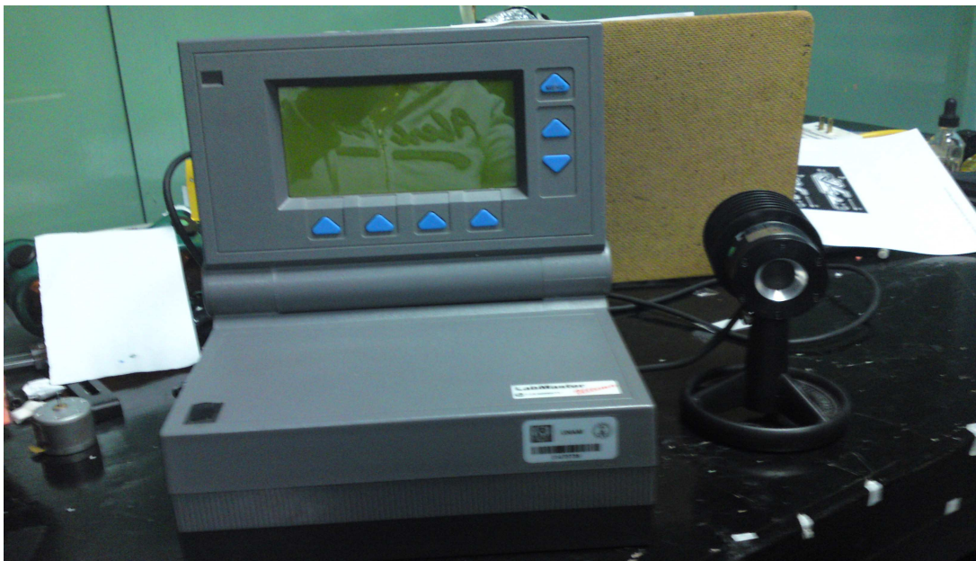
Figura 3.14. Fotómetro Ultima LabMaster empleado.
