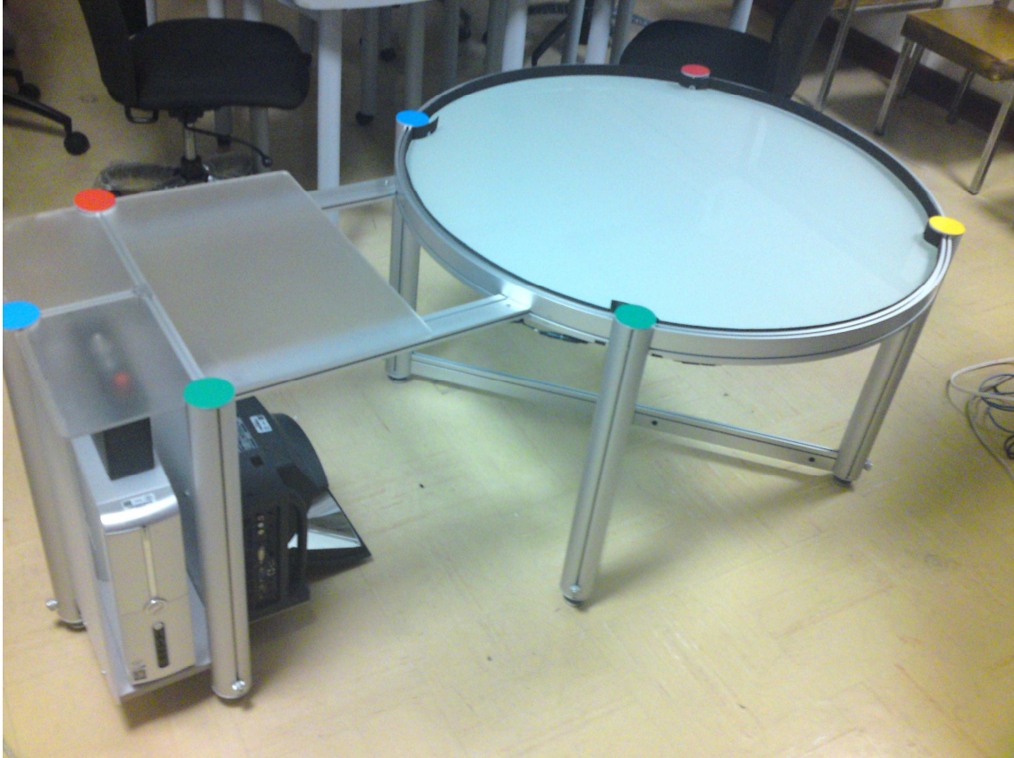
Figura 3.9. Hardware de la superficie interactiva multitouch.
