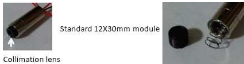
Figura 2.15. Lente colimadora y modulo láser.
