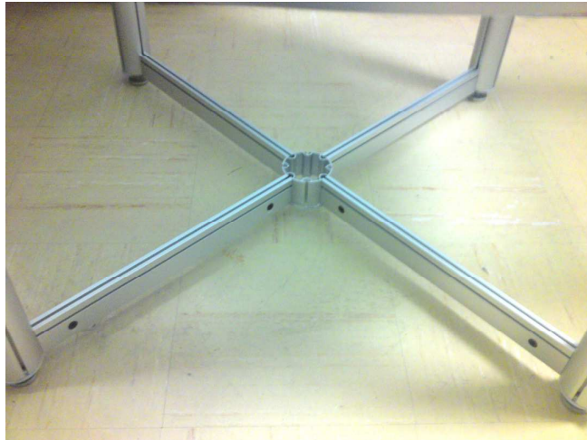
Figura 3.2. Soporte de la cámara.
