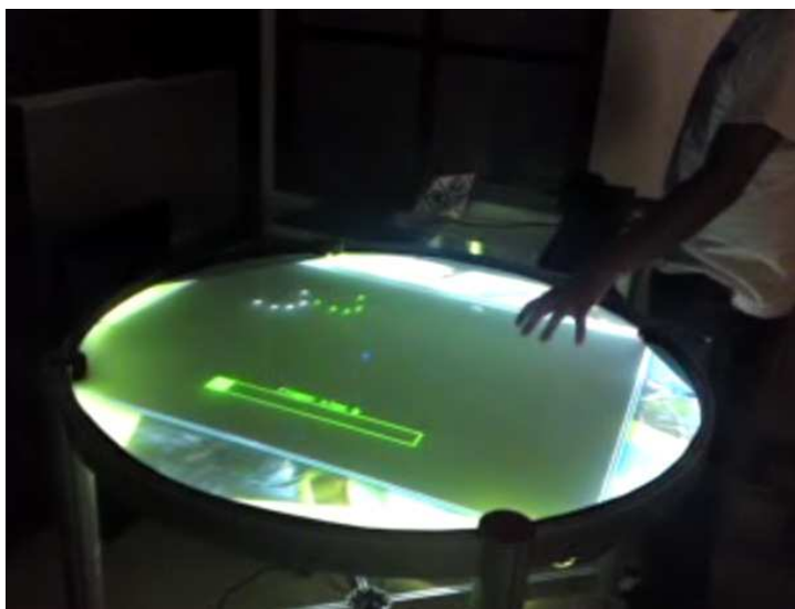
Figura 3.16. Calibración y ajuste de los parámetros de reconocimiento: el contraste, el valor de umbral, el brillo, la velocidad de obturación y la ganancia.
