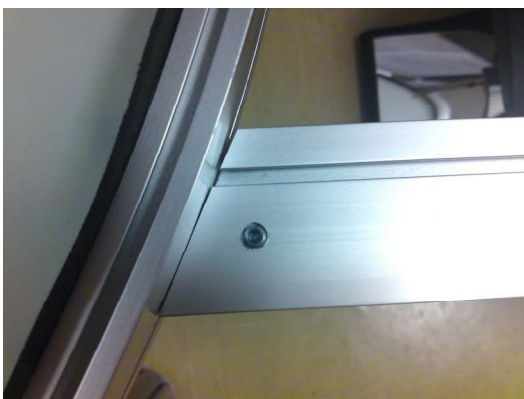
Figuras 3.5. Conexión entre los dos módulos mediante tenso chapas.
