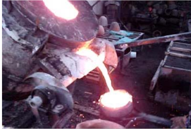
Una fundición industrial, se alcanza a ver que se utiliza una especie de cucharón aparte del crisol. Imagen tomada de internet 20 2006
