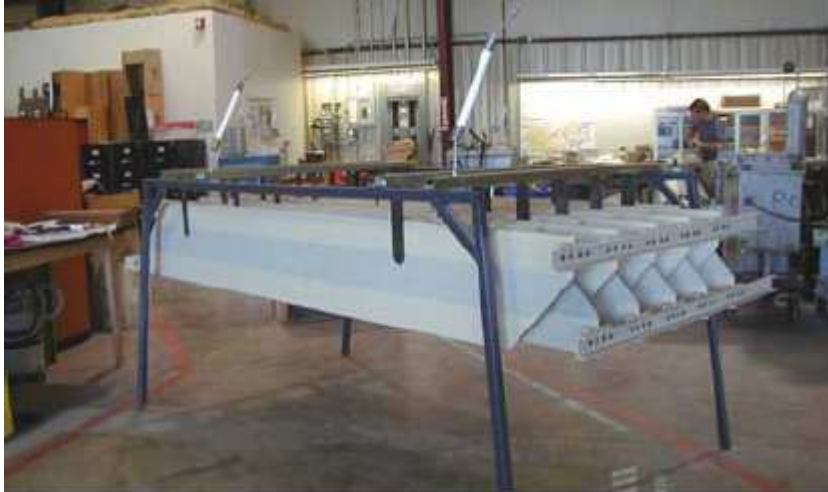
Figure 51: Ejemplo de Arreglo de Electrodos Compuestos en Lab. Ref. Warren Kenneth W. , SPE/NATCO Group New Tools for Heavy Oil Dehydration (2002).
