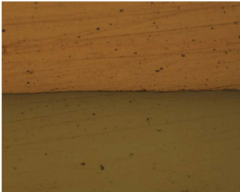
Fotografía 2. Material colaminado acero cobre con precalentamiento a 800°C y dos reducciones de espesor por laminado del 20% a 200 X.
