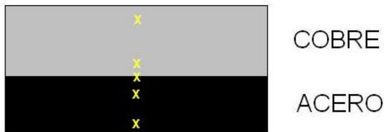
Figura 3.3. Diagrama de ubicación de los puntos donde se midió la microdureza
